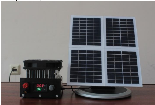
Рис. 1 Малогабаритный прибор «Электронная нагрузка для источников питания» подключённый к тестируемой нагрузкой
